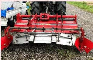
↑農機で引いて畑の畝を作る装置。ゼロから設計・製作。
