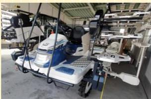
↑スマート農機。土壌センサーを利用して肥料を可変します。
