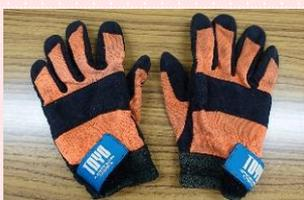
↑防振手袋。チェーンソーの振動から手の血管を守る。
