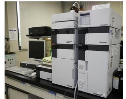
図 3 GPC (SHIMADZU LC-20)
